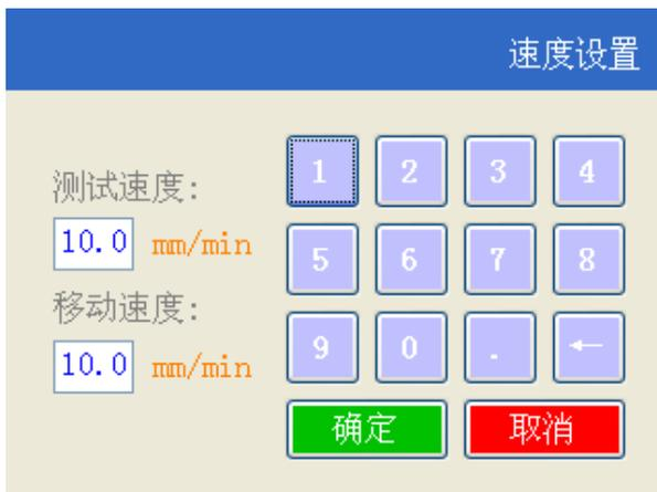
注意：速度设置需在 5~65mm/min 范围内，若设置值低于 5mm/min 将默认为 5mm/min。
